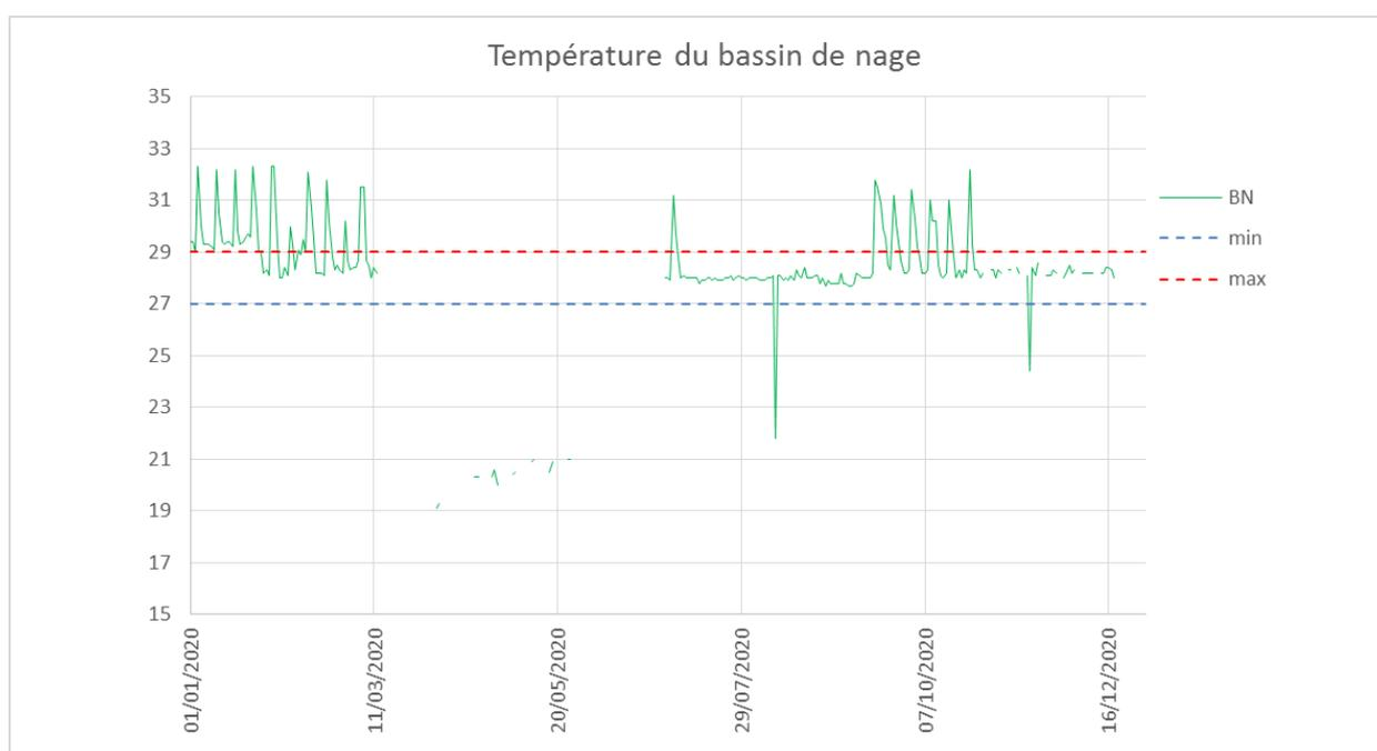
Les fluctuations des températures du bassin de nage proviennent du fait qu'il y a des séances de bébés-nageurs qui demandent une eau plus chaude (32°C). L'inertie sur le bassin fait que la température met du temps à baisser. On remarque que sans l'activité des bébés nageurs, on maintient la consigne de 28°C.
